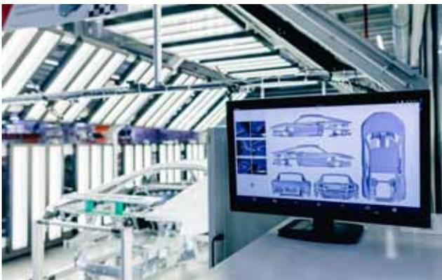
Ein neuer Lichttunnel in der Montage der Böllinger Höfe findet mithilfe von Künstlicher Intelligenz jede noch so kleine Unregelmäßigkeit am fertigen Fahrzeug.
